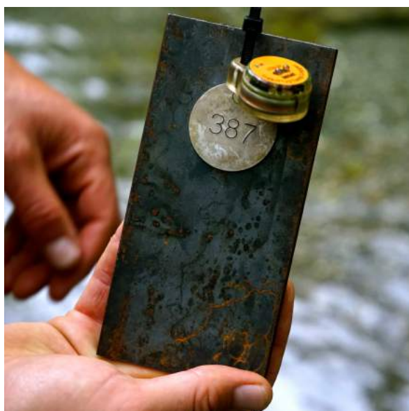
Onset Hobo Tidbit V2 Temp Logger (UTBI-001)
